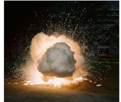
Metallbrand beim Versuch mit Wasser zu löschen
