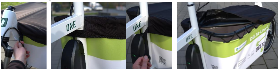
Abbildung 9: Transportbox-Abdeckungs-Befestigung vorne (links) und hinten (mittig) sowie halb geöffnet (rechts)
