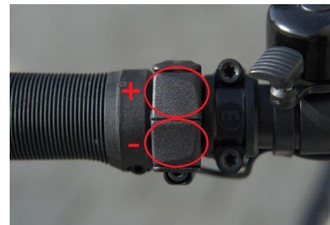
Abbildung 5: Bedienelement für die Unterstützungsstufe am linken Lenkergriff
