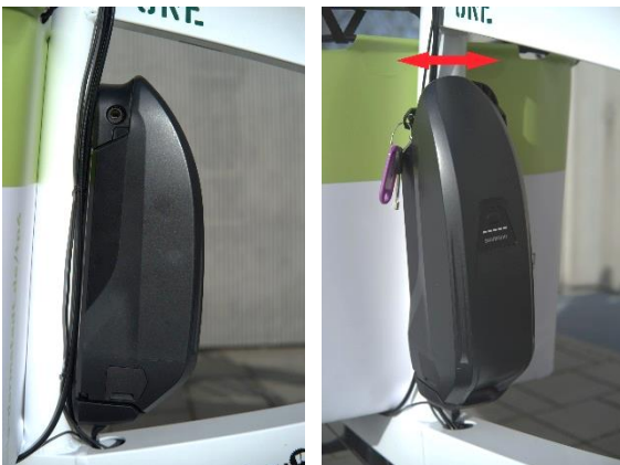
Abbildung 2: Akku in Rahmen (links) und Einrastmechanismus von Akku (rechts)
