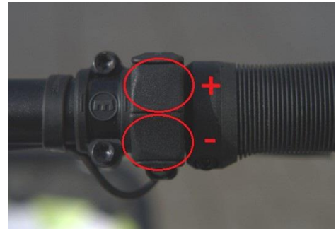
Abbildung 6: Bedienelement für die Gangschaltung am linken Lenkergriff
